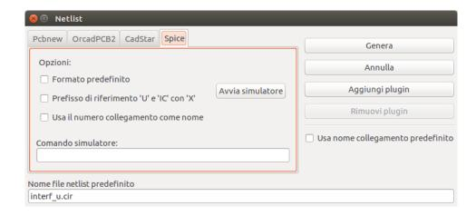
Usando le diverse schede è possibile selezionare il formato desiderato. Nel formato Spice si può generare netlists sia con nomo equi-potenziali (sono più leggibili) o con numeri di collegamento (le vecchie versioni di Spice accettano solo numeri). Facendo clic sul pulsante Netlist, verrà richiesto un nome file per la netlist.
