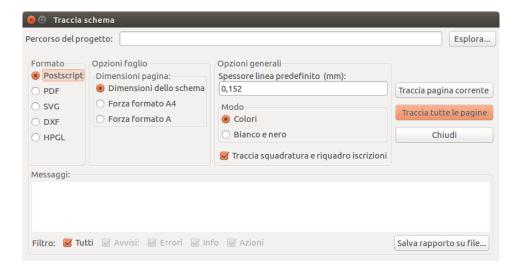
Il nome file è il nome del foglio con estensione .ps. È possibile disabilitare l'opzione "Traccia squadratura e riquadro iscrizioni". È utile se si vuole creare un file postscript per incapsulato (formato .eps) usato spesso per inserire uno schema per esempio in un programma di videoscrittra. La finestra messaggi mostra i nomi (con i percorsi) dei file creati.
