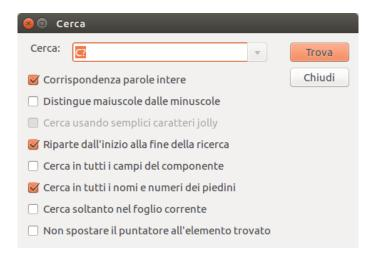
È possibile cercare un riferimento, un valore o una stringa di testo nel foglio corrente o in tutta la gerarchia. Una volta trovato, il puntatore del mouse verrà posizionato sull'elemento trovato nel sotto-foglio in questione.
